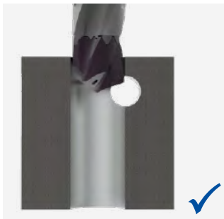
Bohrung außermittig; Querschnitte im Eingriff
