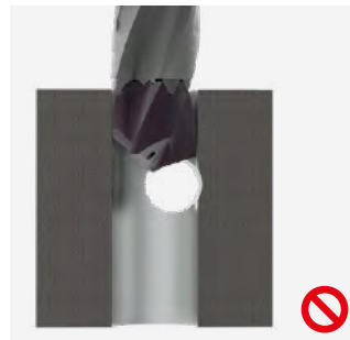
Bohrung außermittig; Querschnitte nicht im Eingriff
