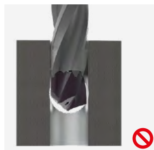
Bohrung mittig und \approx D
