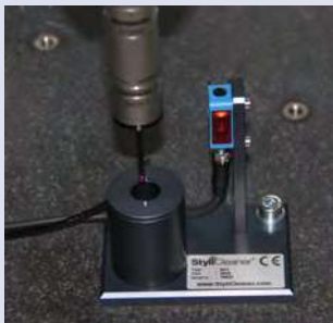
StyliCleaner, hogere nauwkeurigheid door schone tasters
