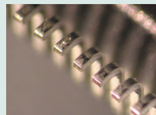
Meetvoorbeeld : Hoogte van verbindingspootjes op een QFP
