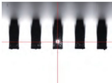
Laser spot van het Tracking Auto Focus systeem (TAF)
