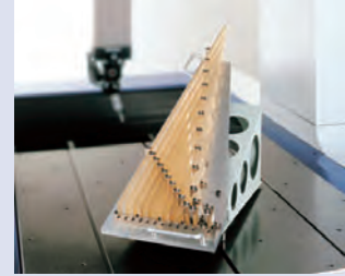
CMM afname uitgevoerd met keramische eindmaten met een uitzettingscoëfficiënt van nagenoeg nul
