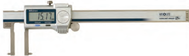
573-646-20 model met puntvormige meetstiften
