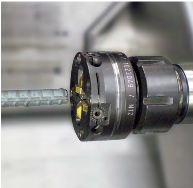
Schälen von Rippenstahl mit FS-Schälkopf Barpeeling of rebar with FS Turning head
