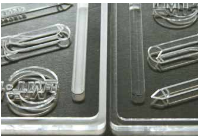
Usinage avec une fraise ED ou CRISTAL Surface state with ED or CRISTAL endmill Oberflächenqualität mit ED oder CRISTAL fräser
