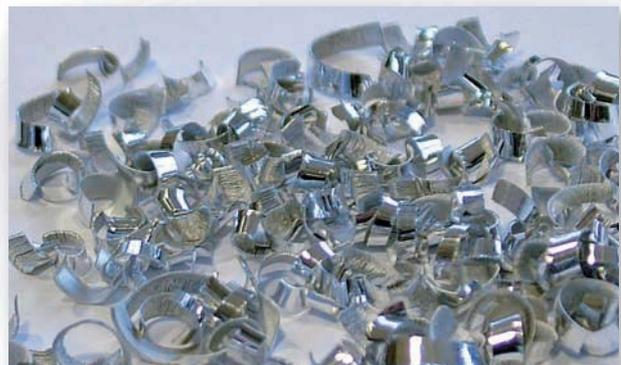
Mit 3D Chip-Breaker: Bruchspäne
