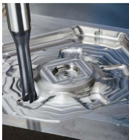
Der MultiEdge 4Feed HSC wurde anstelle eines Torus-Schaftfräzers zum Z-Ebenen-Schruppen eines Felgengesenks eingesetzt. Bei gleicher Schnittgeschwindigkeit von  $v_c = 150$  m/min, konnte die Vorschubgeschwindigkeit auf 4800 mm/min um das 4-fache erhöht werden, die Standzeit verdreifachte sich.
