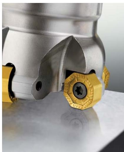
Zum Planfräsen einer Führungsbahn aus GJS-600 wurde anstelle eines 45° Planfräzers mit 8-facher Wendeschneidplatte die MultiEdge Double 8 eingesetzt. Bei einer Schnittgeschwindigkeit von 180 m/min, konnte die Standzeit um 25 % erhöht werden. Durch die 16-fach einsetzbare Wendeschneidplatte ONGU0606 wurde die Anzahl der benötigten Wendeschneidplatten für die Bearbeitungsaufgabe zusätzlich um 50 % reduziert.
