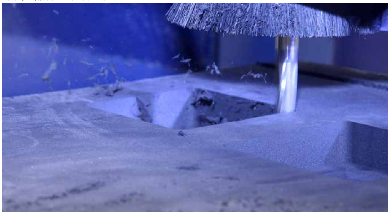
Ouverture de poche dans une mousse dense avec la fraise 60-475 de Ø 12 Pocket opening operation with a Ø 12 endmill - 60-475
