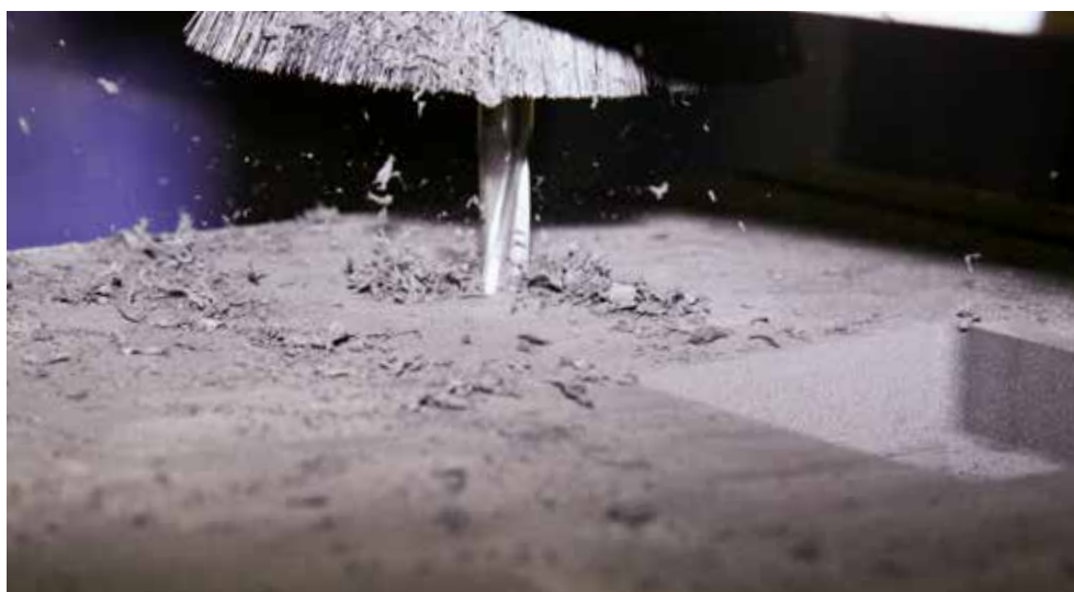
Découpe de mousse avec une fraise 3 dents spéciale mousse 52-744. Foam milling with a three flutes upcut endmill 52-744.
