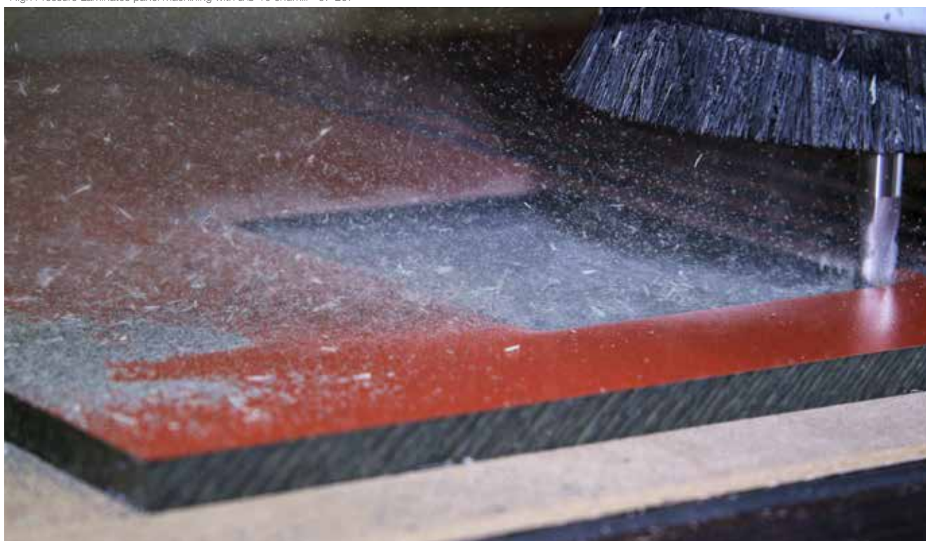
Usinage de panneaux stratifiés compacts avec une fraise 67-207 de Ø 10 High Pressure Laminates panel machining with a Ø 10 endmill - 67-207
