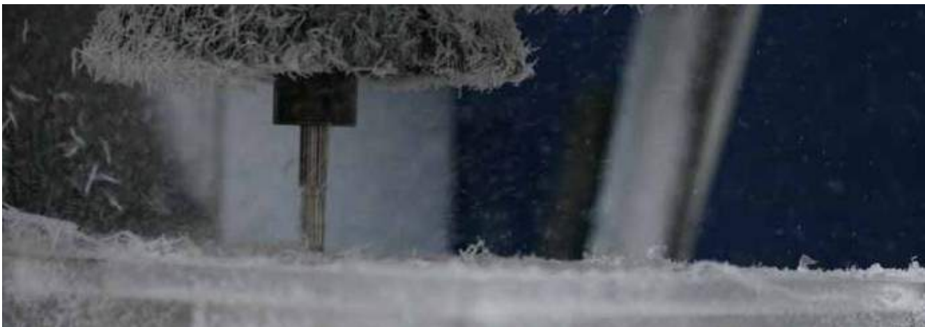
Découpe de PMMA avec une fraise CRISTAL Ø 10 - 53100 Acrylic cutting operation with a CRISTAL Ø 10 - 53100
