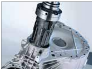
Automobile - Carter boîte de vitesses Fraisage et alésage Aluminium
