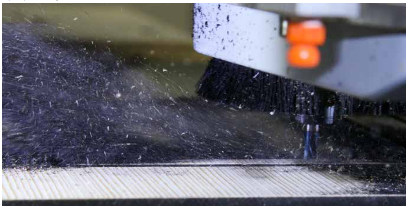
Usinage d'un panneau mélaminé avec la fraise Ø10 - POLAR10 Plywood panel machining with a Ø10 endmill - POLAR10
