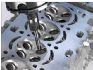
Automobile - Culasse Usinage guides et sièges de soupape
