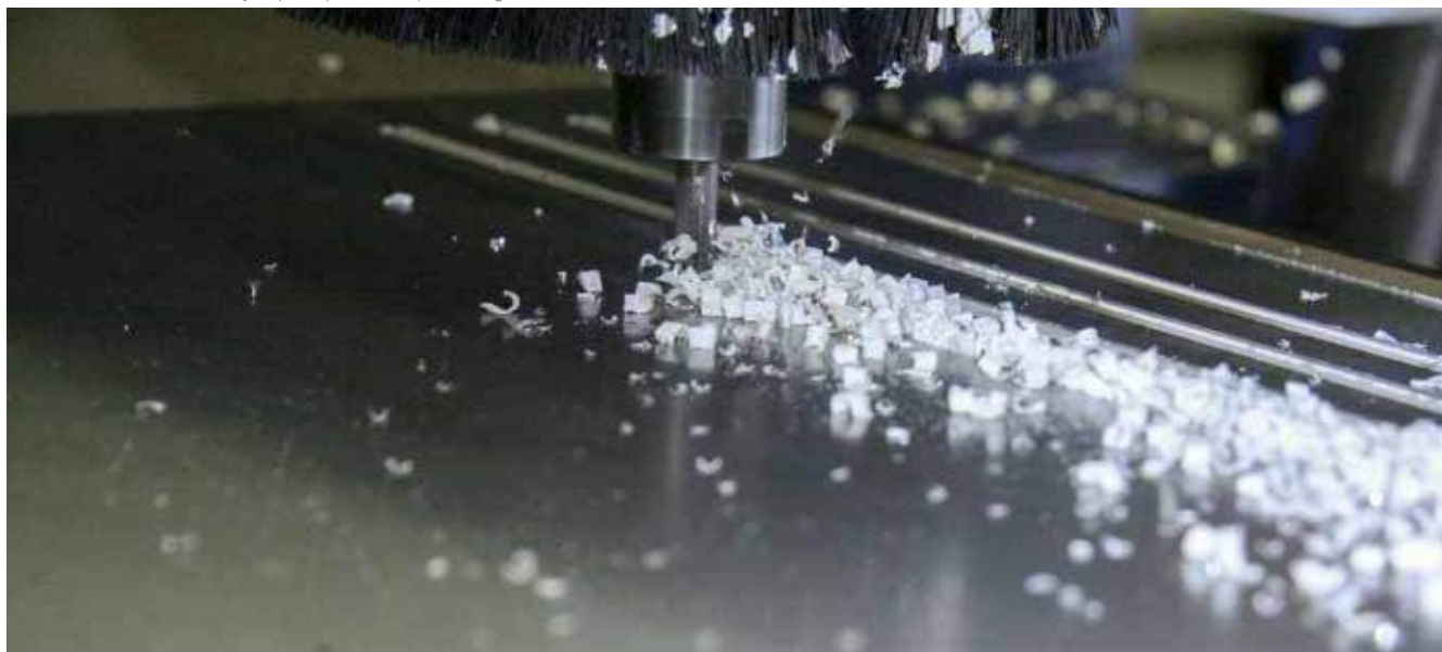
Découpe d'un panneau avec âme minérale et peaux aluminium (classé feu A2) avec fraise Ø 8 - CUTA2D8 Mineral core and aluminum layers panel (fire class A2) machining with a Ø 8 cutter - CUTA2D8
