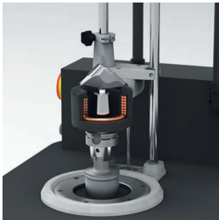
Bild 2 : Positionierung Spule Image 2 : Coil positioning
