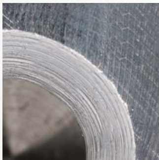
Senkung mit Standard-Senker
