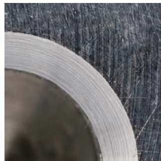
Senkung mit Kegelsenker V-NX
