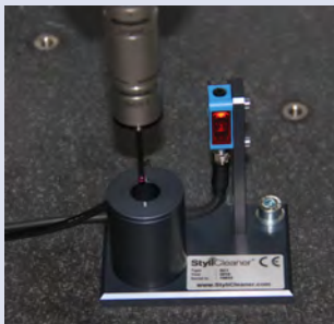
StyliCleaner, hogere nauwkeurigheid door schone tasters
