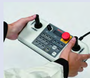
Joystick-box M2 met regelknop voor snelheid, standaard accessoire
