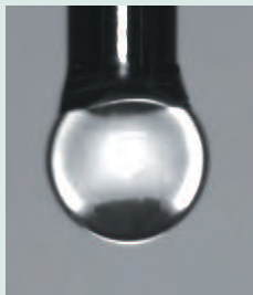
UMAP 130 ø300 µm L = 16 mm
