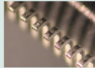
Meetvoorbeeld : Hoogte van verbindingspootjes op een QFP
